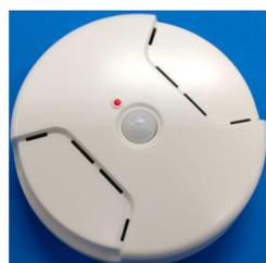
Pas de caméra. Les capteurs relèvent les mesures de température, hygrométrie et CO<sup>2</sup>
